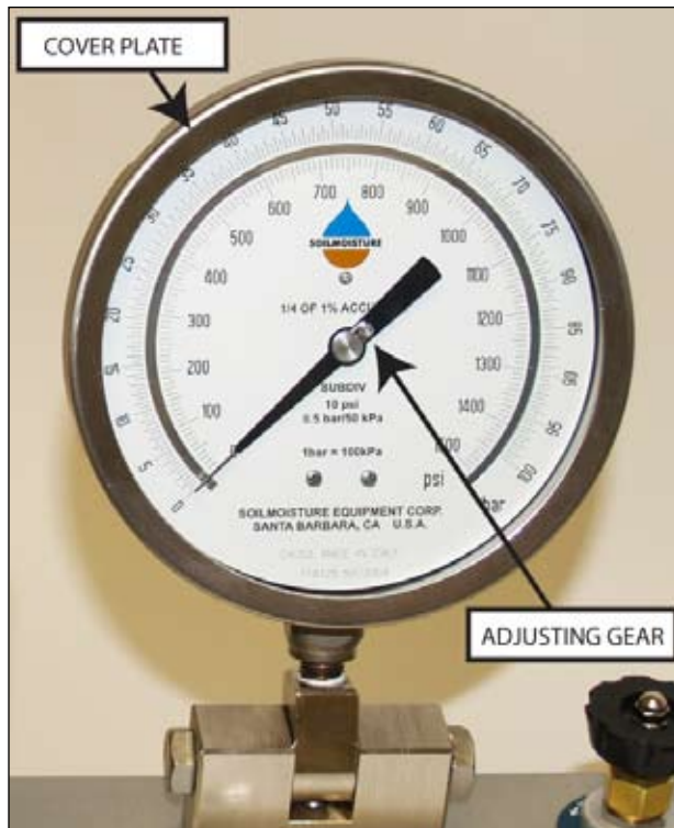
Fig. 20 - Zero adjust
